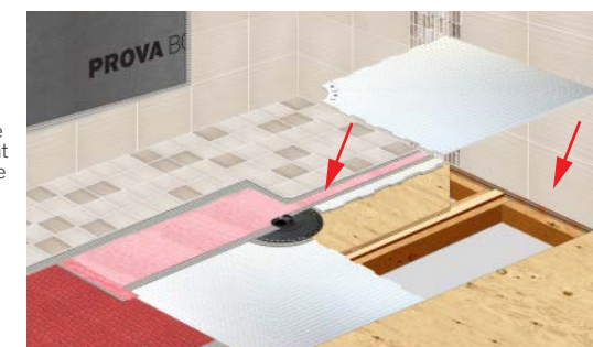
Installation sans seuil par couches complétée
