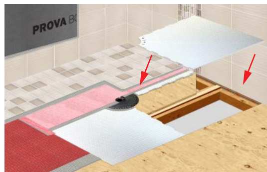
Instalación sin borde completamente estratificada
